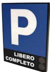
Pannello luminoso di indicazione dello stato di capienza del parcheggio. È provvisto di luci semaforiche rosso e verde. Il pannello è retroilluminato per un'adeguata visibilità notturna.
