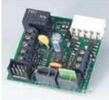
**Scheda di decodifica** monocanale con uscita a relè per pilotare apparecchiature elettroniche FAAC e/o dispositivi ausiliari.
