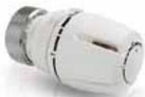
La testina termostatica ZTT, agendo su una valvola termostattizzabile, permette di regolare il flusso di acqua calda nel radiatore. Mediante l'impostazione della manopola graduata, è possibile regolare la temperatura dell'ambiente in un intervallo compreso tra i 6°C e 25°C.
